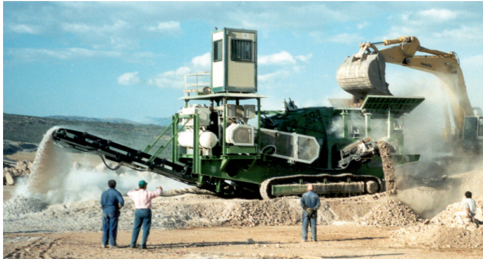
图. 10 Planox®离合器类型PMA-HR 183/0与最大的破碎机之一的福伊特涡轮联轴器650 TG合作。发动机输出P = 550 kW, n = 2100 rpm
